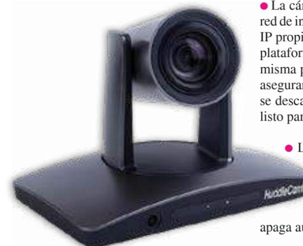
La cámara debe conectarse a una red de internet con DHCP (dirección IP propia), y a una computadora de plataforma Windows conectada a la misma plataforma de internet (para asegurar la comunicación), después se descarga el software y todo está listo para producir.
